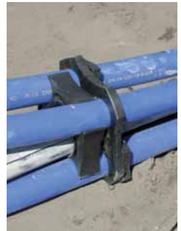
Durch die Abstandshalter wird die Sonde im Bohrloch zentriert; gleichzeitig trennen sie die einzelnen Sondenstränge voneinander. Quelle: LBGR – Schlaak
