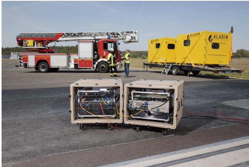
Feldversuch im Mai 2022 Im Bild: Mobile Serverkoffer für die 5G- Übertragung Bild: Philipp Plum/ Fraunhofer FOKUS
