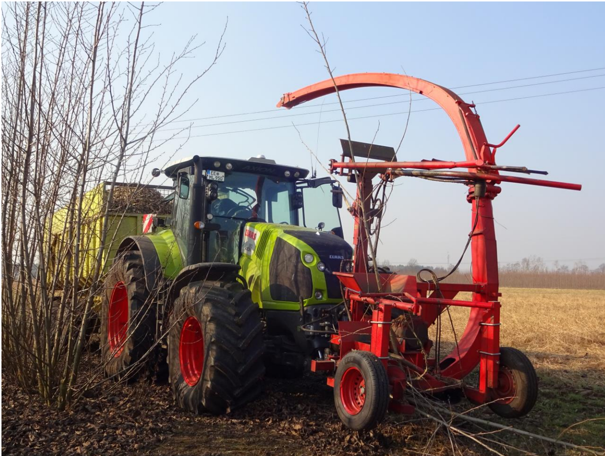
Trennen der Bäume vom Stock und Gutzufuhr bei der einstufigen Ernte mit vertikalem Einzug der Bäume für die bestandsschonende Ernte; Landgraf et al., 2016
